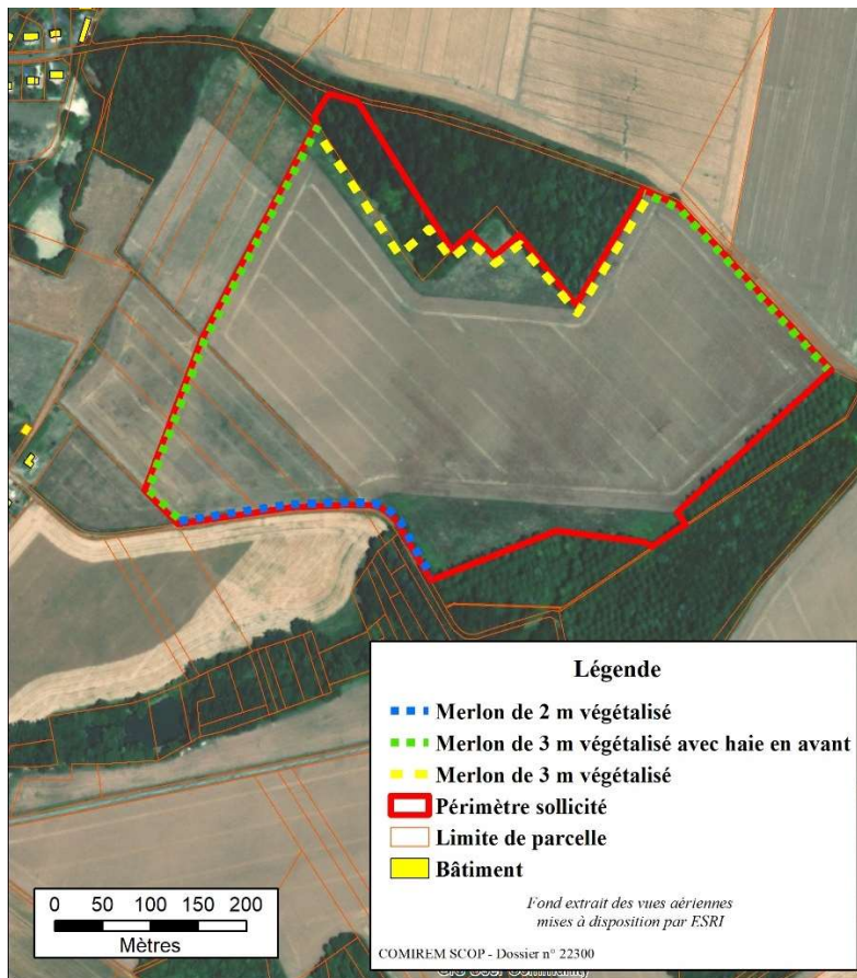
Figure 5 : Localisation des merlons autour du site
